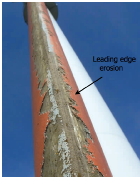
Figuur 3. LEE: (Leading Edge) Erosie van de epoxylaag van een turbineblad
